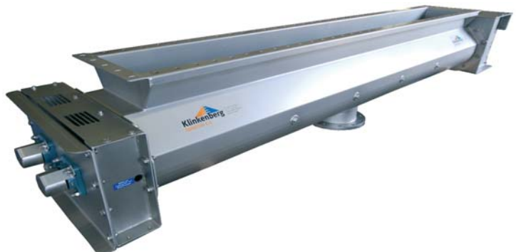
Paddelmischer mit Zweiwellenantrieb mit Stiften zum Brechen von Agglomeraten, die beim Mischen von klebrigen Produkten entstehen.
