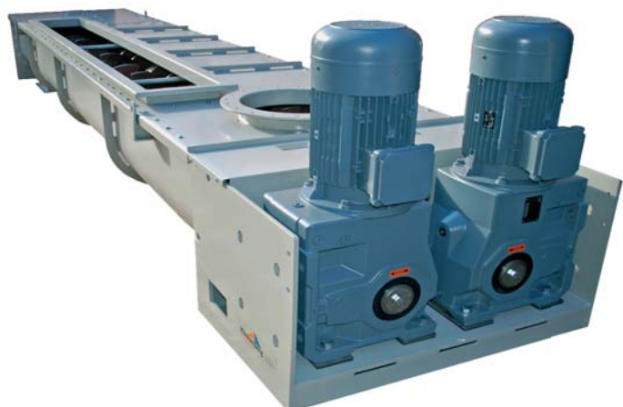
Paddelmischer mit Zweiwellenantrieb zum Mischen von Flugascheschlamm mit trockener Flugasche. Die Wellen werden separat angetrieben. Die Paddel werden aus gehärtetem Stahl mit aufgeschweißtem Vautid 100 gefertigt. Die durchschnittliche Härte beträgt 750 bis 1000 HV.
