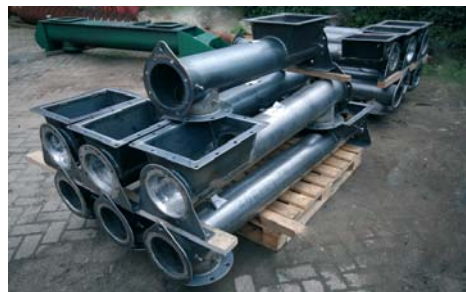
Produktion der Rohrschneckengehäuse aus Stahl.
