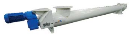
Rohrförderer aus Stahl 37.
