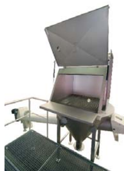
Sackentleerung mit Zufuhr zu einer Dosierschnecke.
